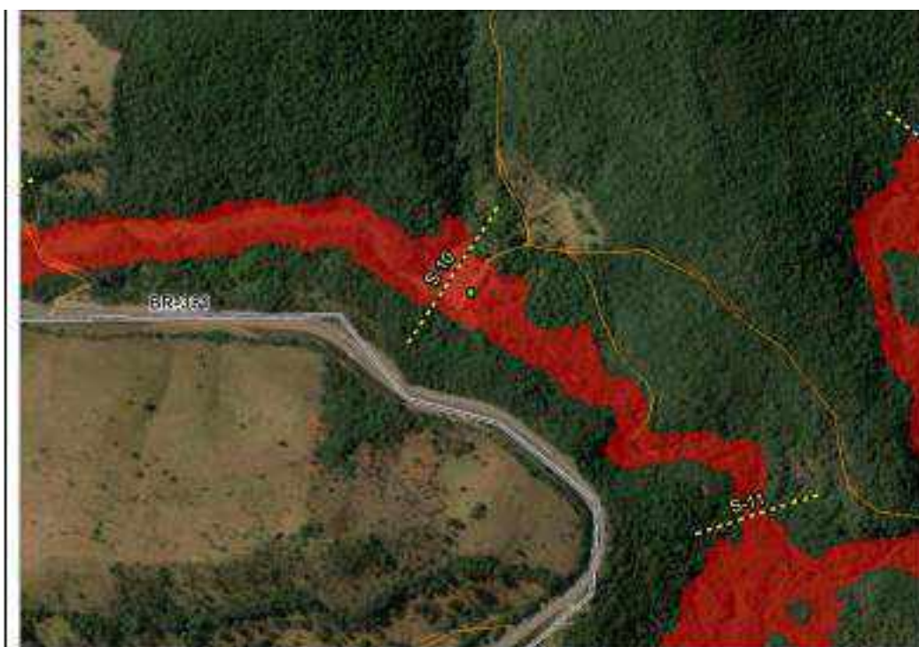
Figura 22 – Pontos de vulnerabilidade à jusante considerando as Seções Notáveis S-10 e S-11, com destaque para barragem sem dados disponíveis. Fonte: Dam Break – DM+ Engenharia Geotécnica e Recursos Hídricos (Dez/20).
