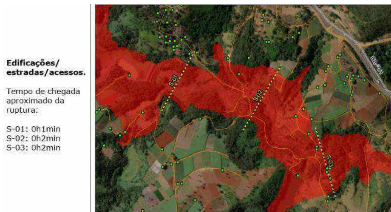
Figura 20 – Pontos de vulnerabilidade à jusante considerando as Seções Notáveis S-01, S-02 e S-03, com destaque para edificações, estradas e acessos. Fonte: Dam Break – DM+ Engenharia Geotécnica e Recursos Hídricos (Dez/20).
