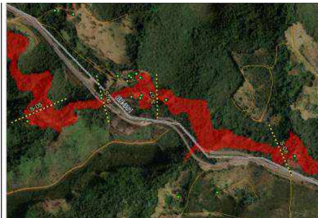
Figura 21 – Pontos de vulnerabilidade à jusante considerando as Seções Notáveis S-05, S-06, S-07 e S-08, com destaque para edificações e para a Rodovia Federal BR-381. Fonte: Dam Break – DM+ Engenharia Geotécnica e Recursos Hídricos (Dez/20).
