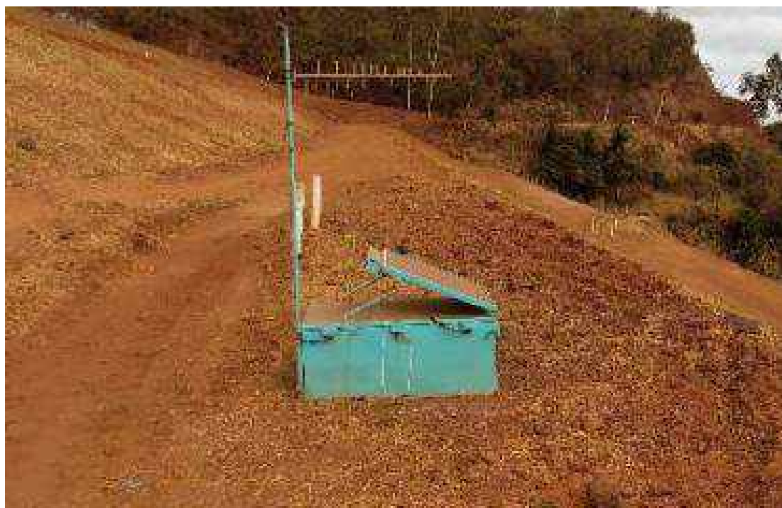
Figura 9 – Instrumentação de Controle – Sismógrafo. Fonte: RISR – 2º Semestre de 2021 (09321-S-BA-RL-02-GE_r1).
