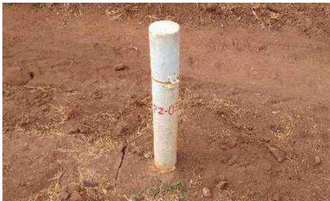
Figura 8 - Instrumentação de Controle - Piezômetro. Fonte: Fonte: RISR - 2º Semestre de 2021 (09321-S-BA-RL-02-GE_r1).
