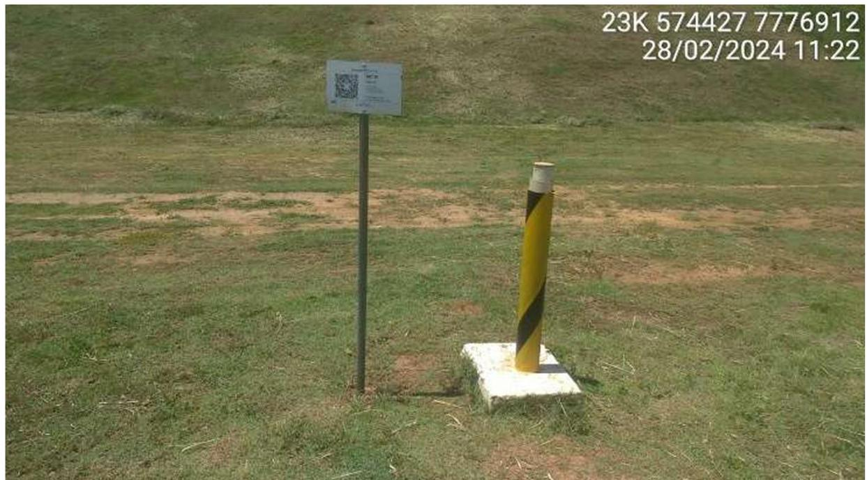
**Figura 19 – Instrumentação de Controle – Inclinaçãometro.**
