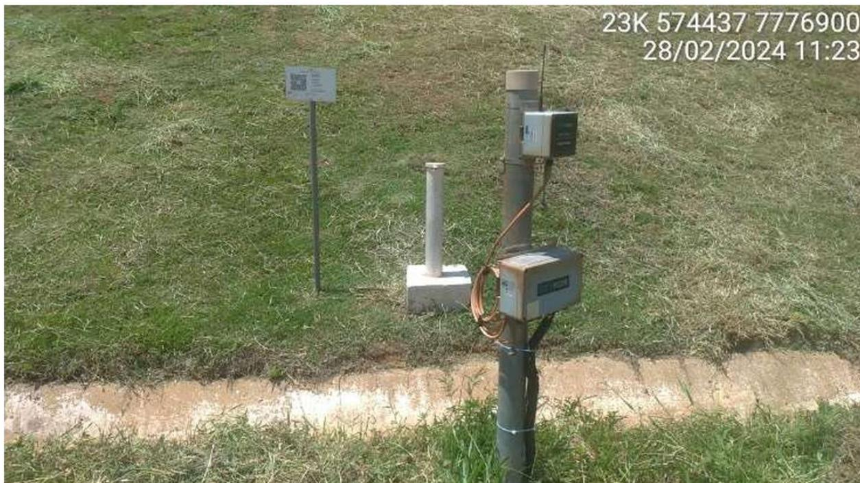
**Figura 16 – Instrumentação de Controle – Piezômetro Automatizado.**
