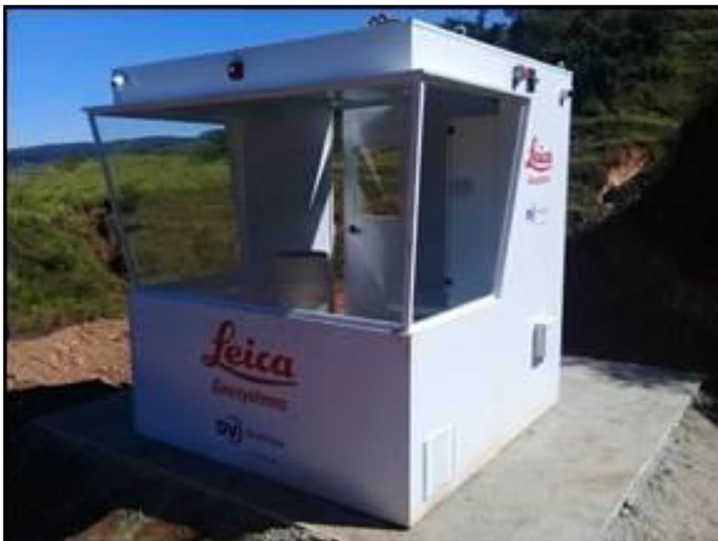
**Figura 26 – Estação de monitoramento robótico com imagens *online* (instalada na base da barragem) que realiza leitura da estabilidade através dos 70 prismas.**
