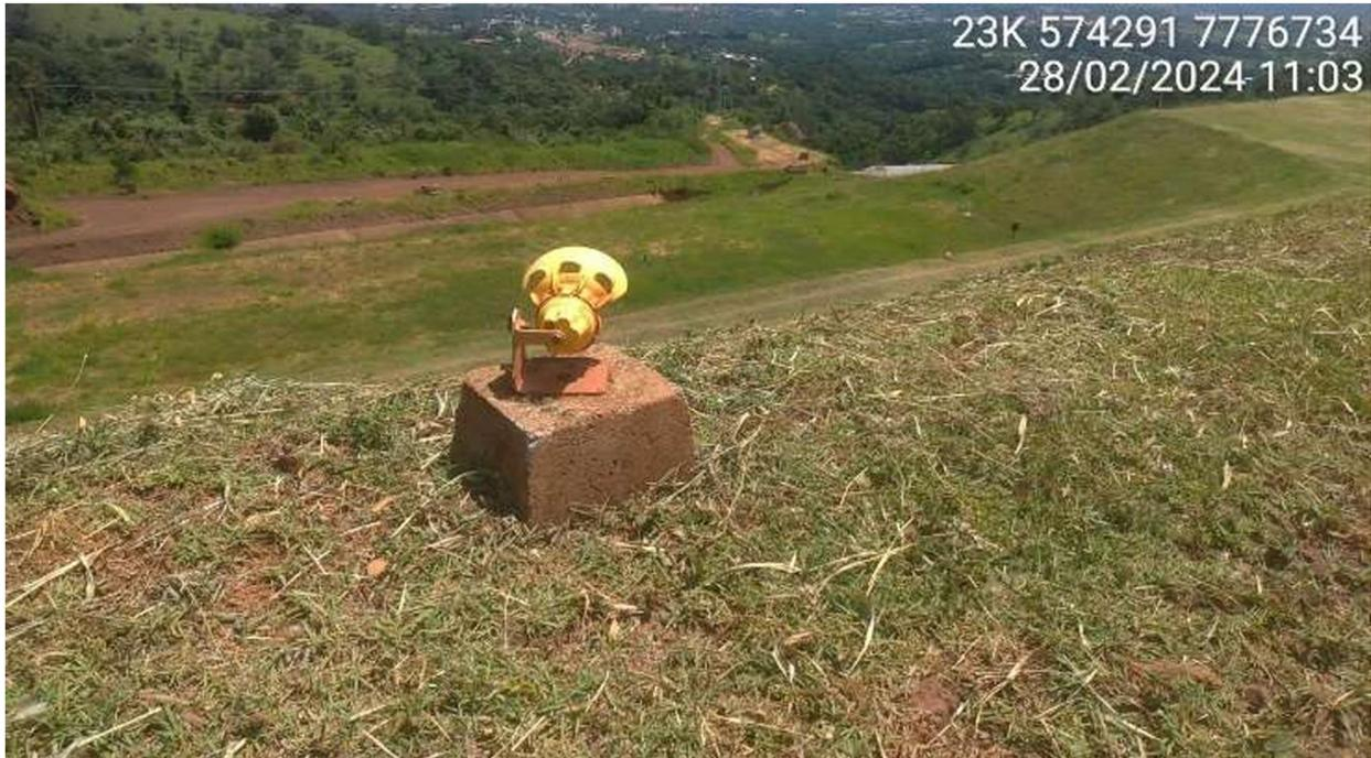
**Figura 18 – Instrumentação de Controle – Prismas de Deslocamento.**
