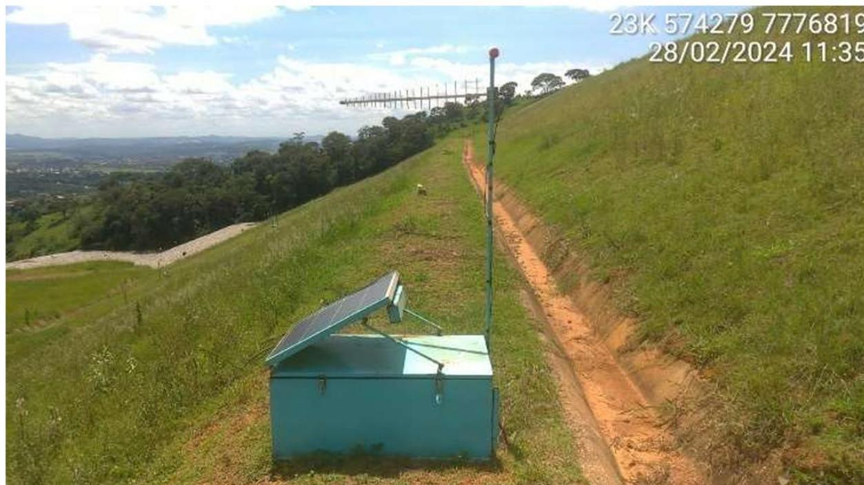
**Figura 17 – Instrumentação de Controle – Sismógrafo.**
