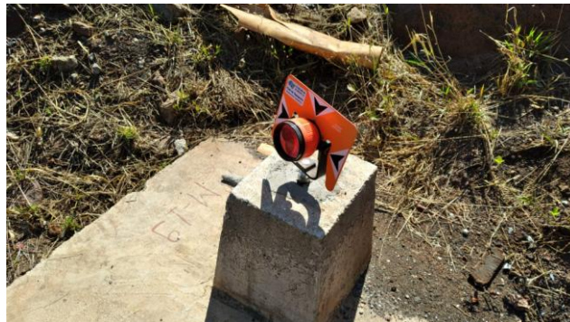
Foto 5-11 - Prisma de monitoramento na encosta
