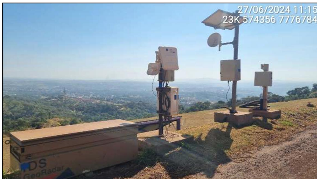
Figura 22 – Radar instalado para acionamento automático das sirenes.
