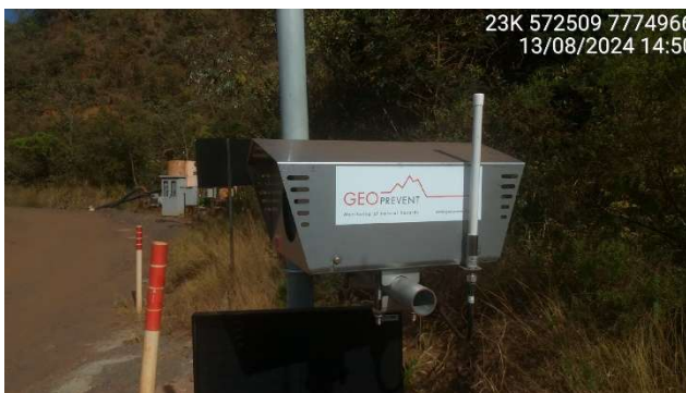
Foto 5.11 – Detalhe da câmera DEFOX.
