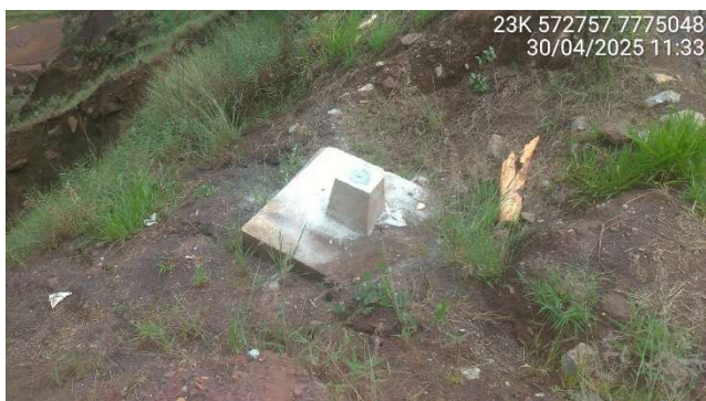
Foto 5.8 – Marco de deslocamento instalado na encosta.
