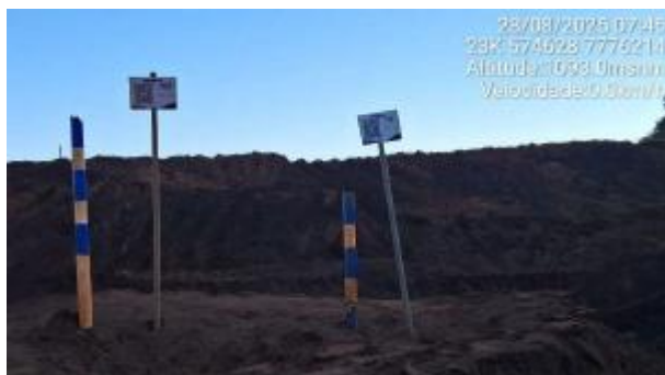
Foto 6-9 - Instrumentos rebaixados – INA-26 e PZ-19.
