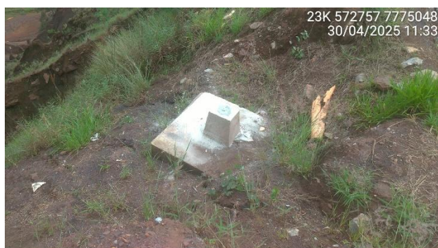
Foto 5-5 – Marco de deslocamento instalado na encosta.
