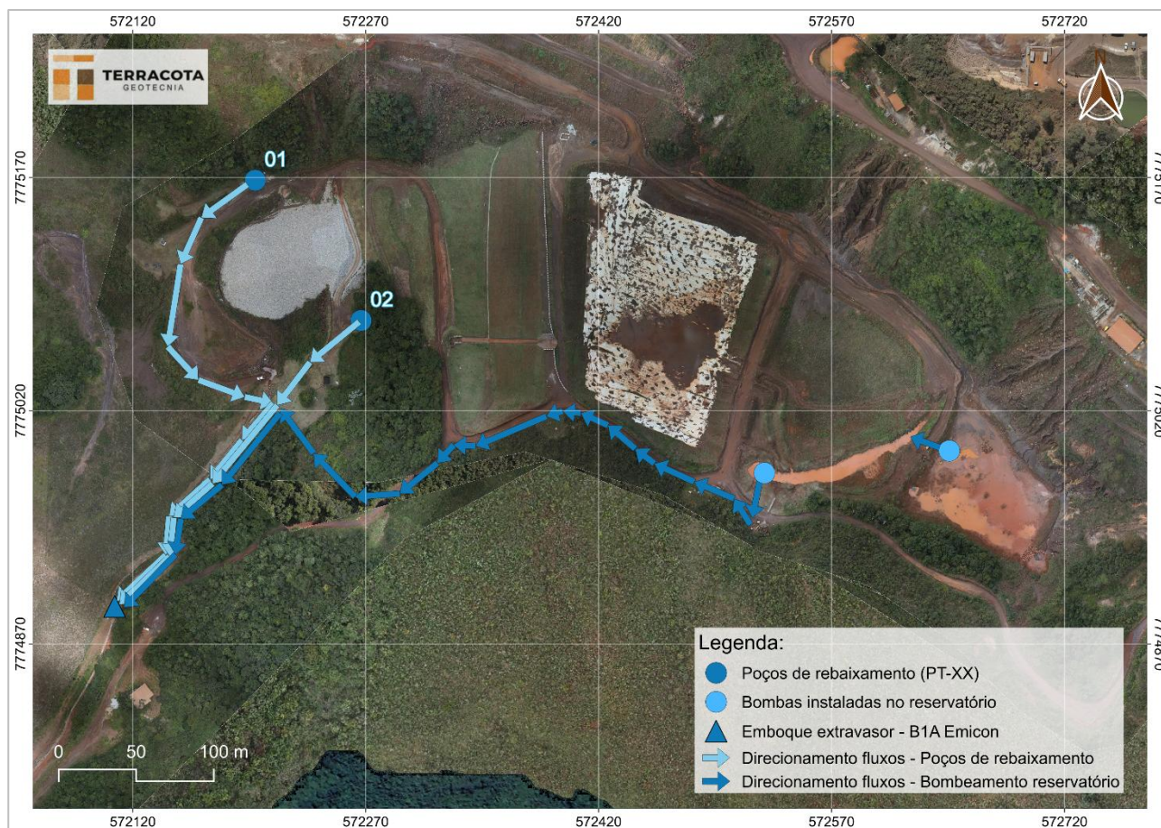
Figura 5.49 – Esquema de direcionamento atual dos fluxos proveniente dos sistemas de bombeamento.
