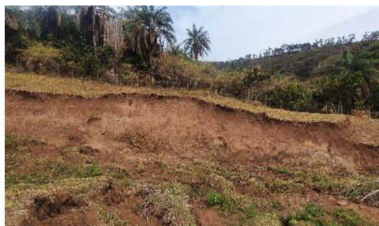
Figura 3-23: Superfície de ruptura de um movimento de massa do tipo esgorregamento, em área a oeste da PDE, no Ponto 2 (coordenadas 572705.63 m E; e 7776398.45 m N).
