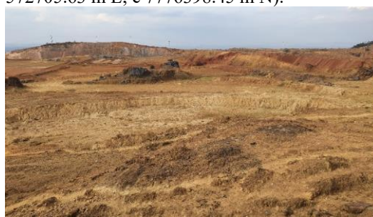
Figura 3-25: Processos erosivos incipientes do tipo laminar em área de aterro, nas imediações da antiga área da MMX (leste da ADA). Coordenadas: 576414.00 m E; e 7776664.00 m N. Ponto 4.
