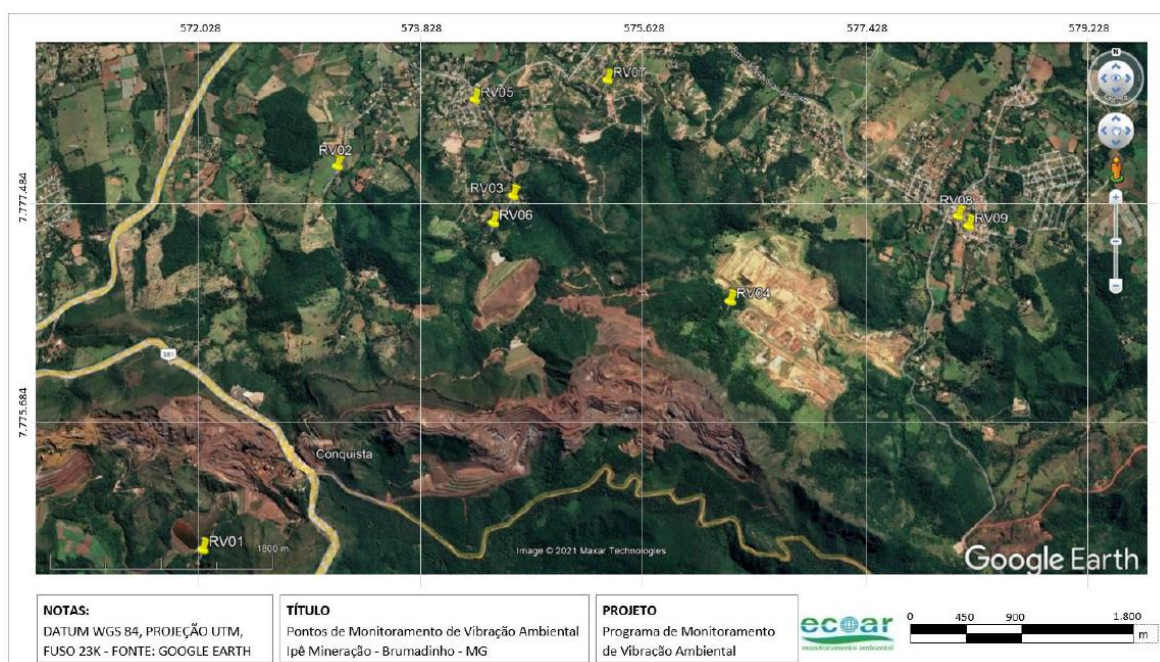
Figura 3-7: Pontos de monitoramento de vibração.
