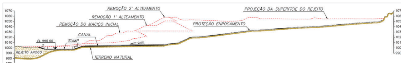
Figura 5.16 – Seção transversal passando pelo vale após a finalização das obras.
