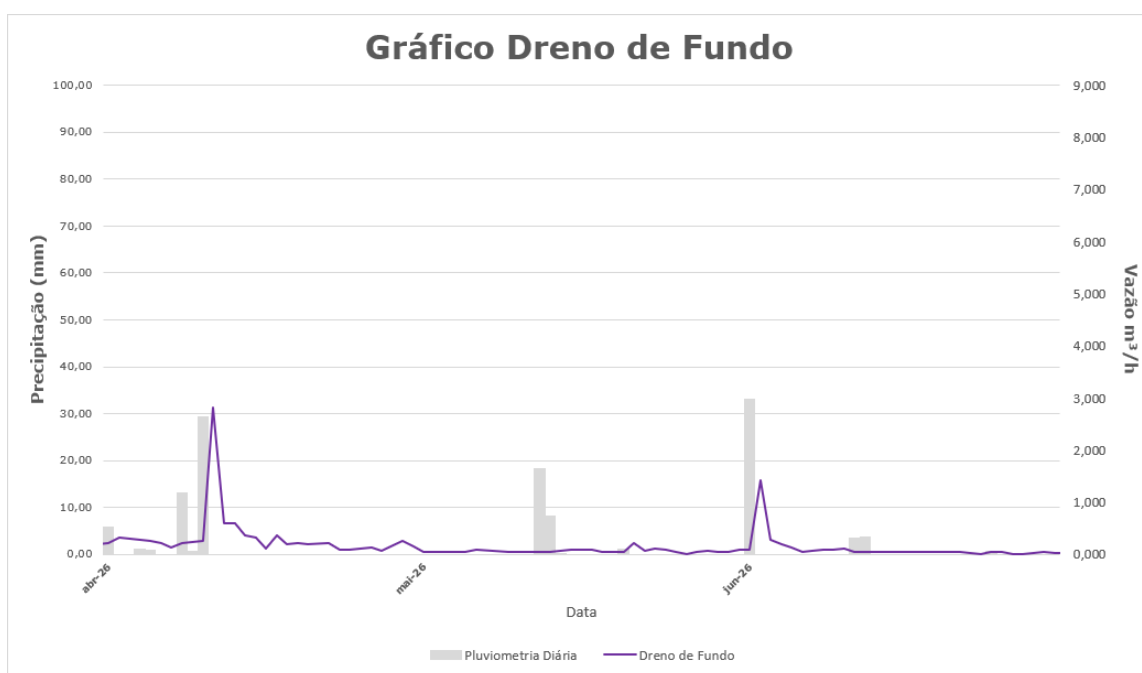
Figura 7-21 - Histórico de leituras da vazão de drenagem interna Barragem B1-Auxiliar
